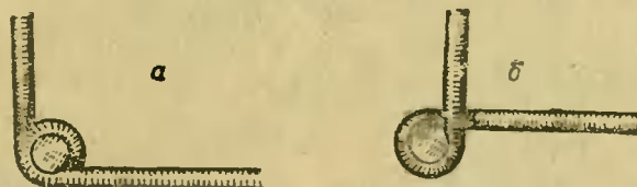
Рис. 39. Правильное (а) и неправильное (б) закрепление звонковой проводки при повороте на 90°.
