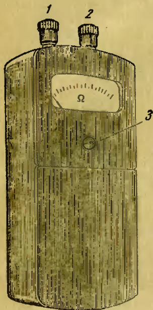
Рис 75. Омметр типа М-57: 1, 2 — зажимы для включения измеряемых сопротивлений, 3 — корректор для установки стрелки.
