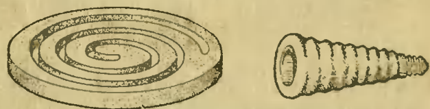
Рис. 45. Теплоизоляционные основания нагревательных приборов из шамота.
