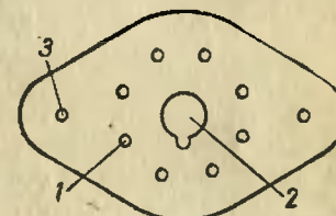
Рис. 162. Панелька для электронной лампы в схеме прибора: 1 — гнезда под контактные штырьки, 2 — отверстие для направляющего ключа, 3 — отверстия для крепежных болтиков.
