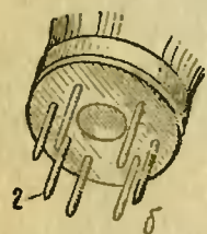
Рис. 163. Размещение выводных контактных штырьков на цоколе металлических и стеклянных ламп (а) и пальчиковых (б): 1 — управляющий ключ, 2 — выводные контактные штырьки.
